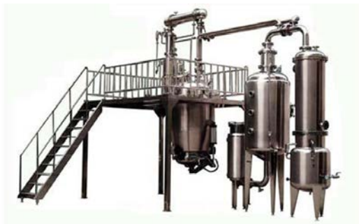
Figura 7-3: Sistema de extracción por solvente agua:etanol de escala comercial, manufacturado por Wenzhou Taikang Evaporator Co., Ltd
