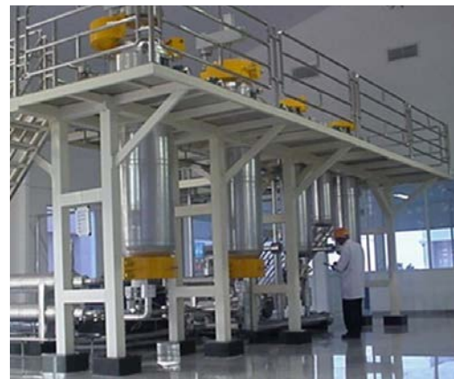
Figura 7-4: Sistema de Extracción por CO 2 supercrítico de escala comercial, manufacturado por Deven Supercriticals Pvt. Ltd.
